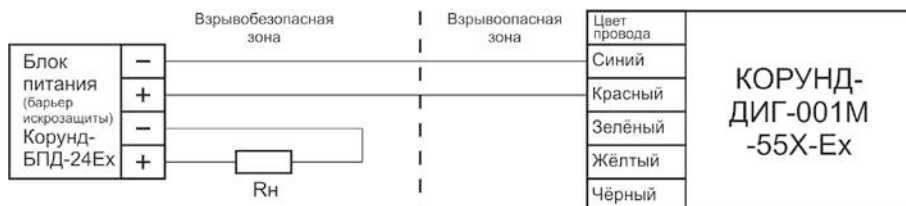
Рис.Б6. Схема соединений датчиков КОРУНД искробезопасного исполнения с блоком питания, имеющим встроенный барьер искрозащиты.
